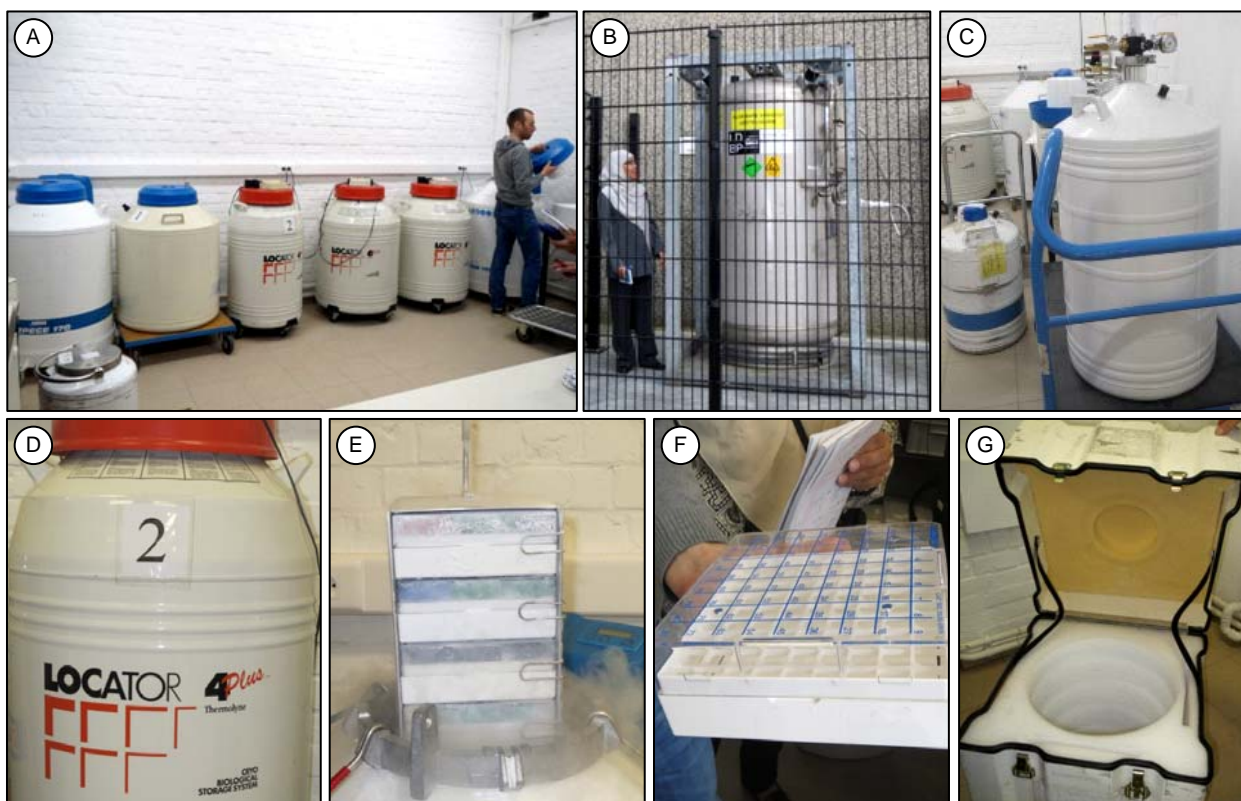
Gambar 2. Ruang dan peralatan yang diperlukan pada konservasi secara kriopreservasi. A = Ruang inkubasi yang terdiri atas tangki penyimpanan dengan kapasitas 150 l, B = Tangki reservoir, C = Tangki pengisian, D = Tangki penyimpanan, E = Cryo racks, F = Cryo box, dan G = Tangki transfer.
